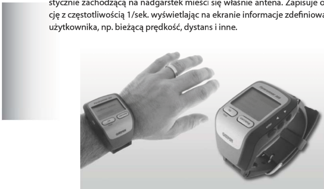
Fotografia 2. Odbiornik naręczny Garmin Forerunner 305 (prod. od 2007 r.)
