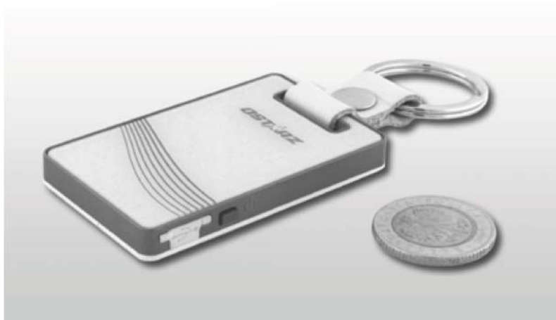
Fotografia 3. Rejestrator Qstarz BT-Q1 300st (prod. od 2010 r.) w porównaniu z monetą pięciozłotową.
