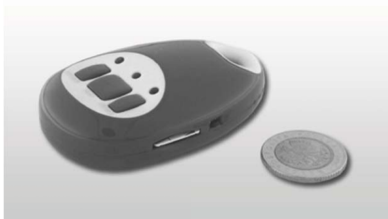
Fotografia 4. Lokalizator GPS CCTR–612 w porównaniu z monetą pięćzłotową.
