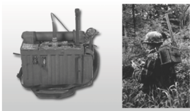
Fotografia 1. Rockwell Manpack AN/PSN-8 (lata 80-te)
