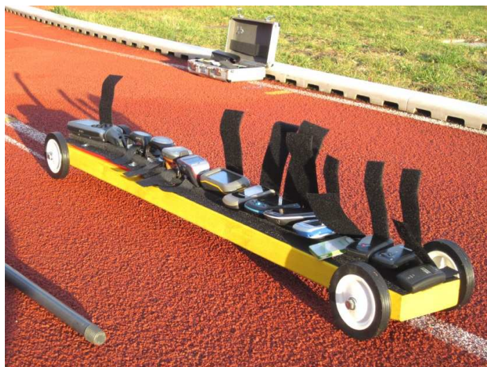
Rys. 7. Rozmieszczenie urządzeń na wózku pomiarowym
